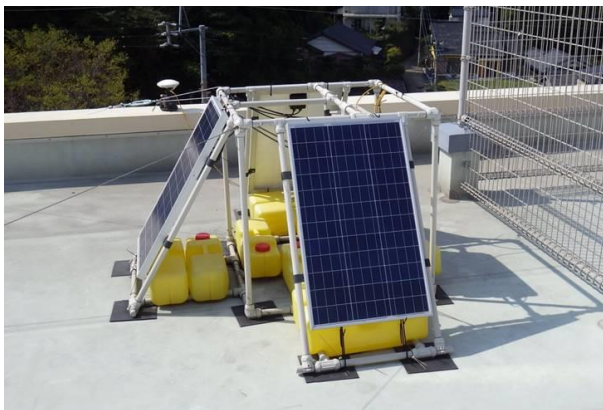
GNSS 地殻変動観測装置
